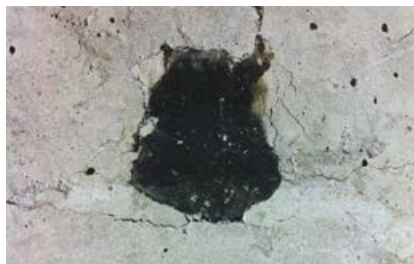
Близък план на сечението на бетона, който показва набъбващите свойства на водонабъбващата лента PENEBAR SW.
