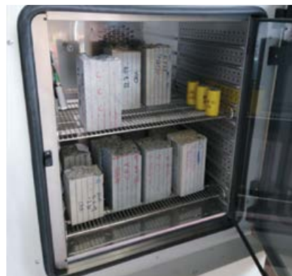
Климатична камера с призма за ускорена карбонизация (швейцарски стандарт SIA 262/1-X)
